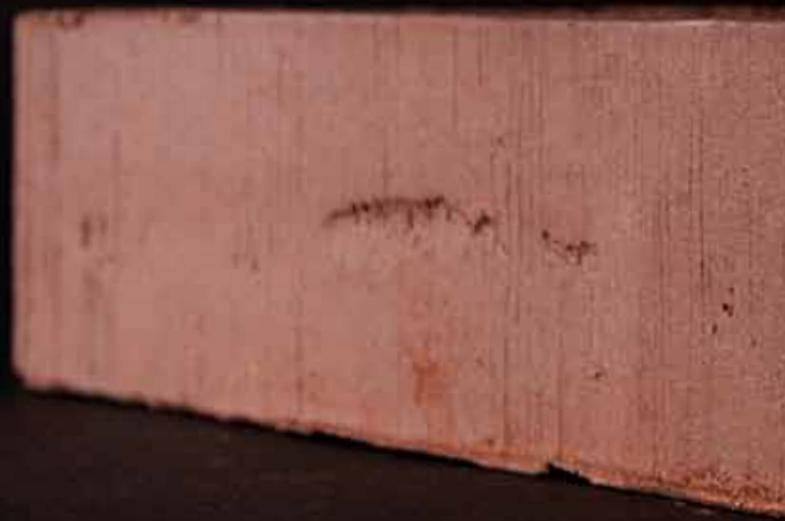
typique des briques décoffrées à l'eau. Avec leurs fines nervures et leurs légers biseaux, elles semblent issues du pressage de l'argile dans un moule, puis décoffrées selon la méthode Wasserstrich.
